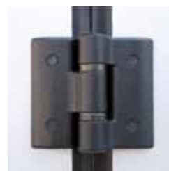
CERNIERA in alluminio pressofuso a due ali, completa di due cuscinetti a sfera, verniciata nera, con portata 150 kg.
